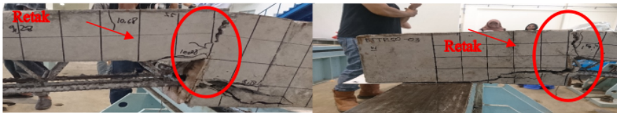
Gambar 1. Retak pada daerah tumpuan balok bertulang sistem rangka
